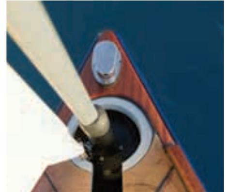
**Versenkt.** Die Rollanlage für das Vorsegel ist im Bug eingelassen
