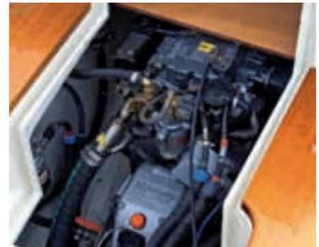
**Speziell. Der Motor ist invers installiert. Der Saildrive sitzt vor dem Aggregat**
