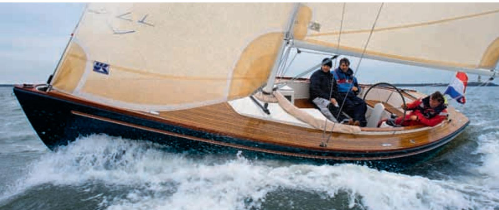
**Schick. Der neue Daysailer von Saffier gefällt optisch mit seinen klaren, unverbauten Linien. Auf einen Kajütaufbau wird gänzlich verzichtet. Die Steuerung mit Ruderrad gibt es auf Wunsch. Standard ist die einfachere Pinnensteuerung**
