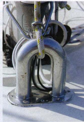
Verbunden: Die geschlossene Überleitung der Elektrokabel verhindert das Verhaken
